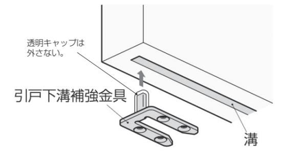
下溝補強金物取付け位置図
