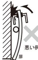
△取付位置注意 ドアキャッチャーをヒンジ側方向に取付けたり、壁際ギリギリの位置などに取付けますと扉のしなりでレバーハンドルが壁に接触することがありますので扉との余裕を見て検証しながら位置を決めてください。
