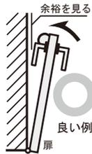
本体を取付ける位置は、ストライクが扉の端から10～100mmの間の位置にくるように設置してください。また、扉を開けた時にレバーハンドルが壁に接触しない位置に取付けてください。
