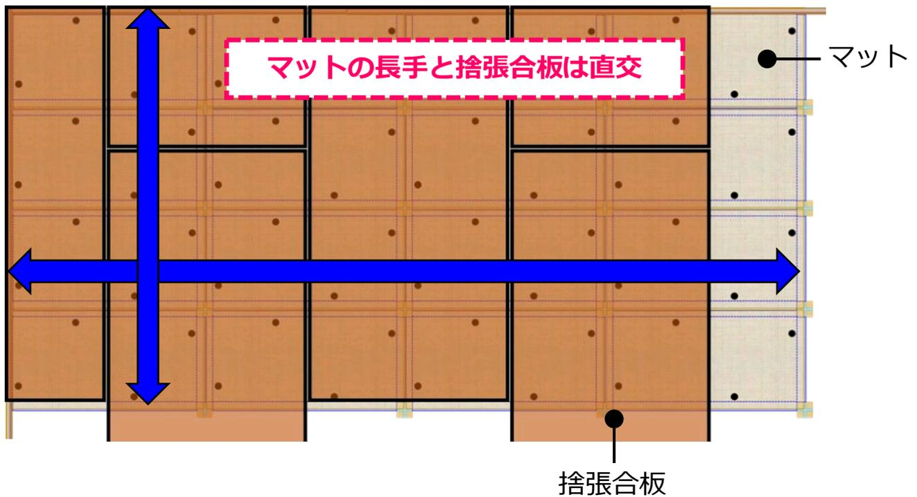
捨張合板は壁から10mmの間隙を確保し、マットの端部と面合わせになるように敷いてください。
